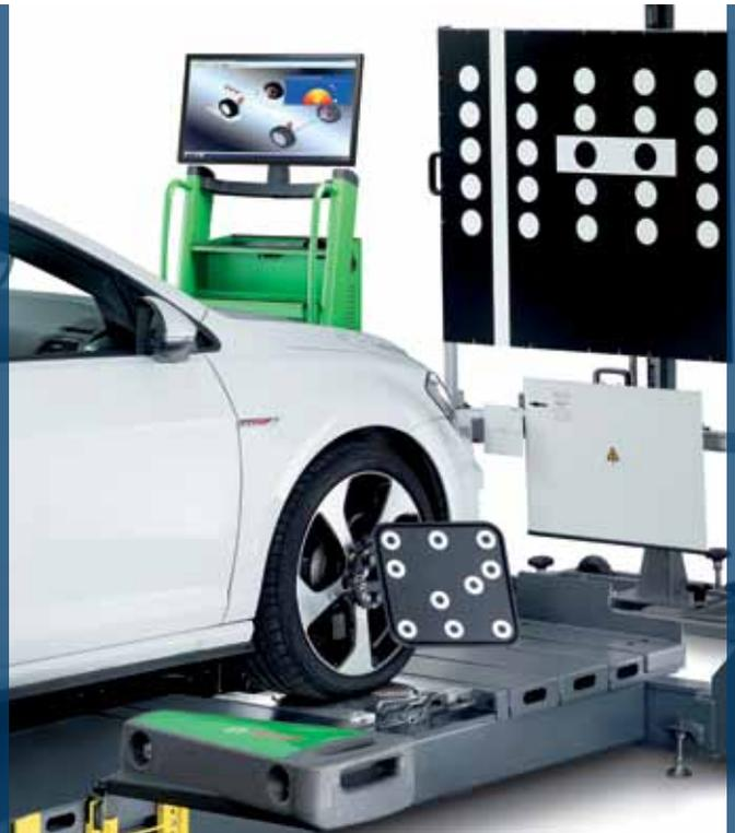
Kompletter Achsmessplatz mit VAS 6430 und perfekt nivellierter Bühne
