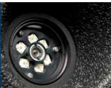
12 Kameras mit 3D-Technologie von Bosch mit Absolut- und Wiederholgenauigkeit von +/- 2 Minuten für Spur und Sturz
