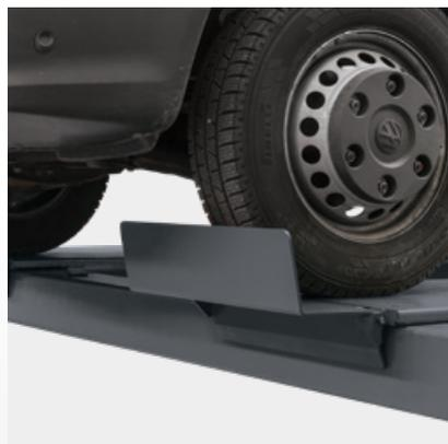
1 Die 4-Säulen-Hebebühne ist mit einer pneumatisch entriegelbaren Absetzvorrichtung (alle 100 mm) ausgerüstet. Seile und Hydraulik werden so entlastet. Die einstellbaren Klinkenleisten in den Hubsäulen ermöglichen eine absolut waagerechte Ausrichtung der Hebebühne.
