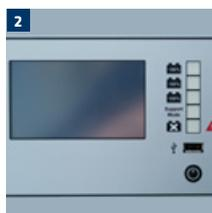
**1** Batterieladegerät mit USB-Anschluß für Software Updates, um eventuell neue Kennlinien aufzuspielen - so ist das Gerät immer auf dem aktuellen Stand
