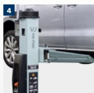
**1** Heben und Senken über komfortable beidseitig angebrachte Drucktasten (nur bei VAS 771033; bei VAS 771031 optional).
