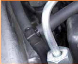
Nachdem die Rückflussleitungen des Injektors abgekoppelt sind, müssen diese mit einer Klemme verschlossen werden um zu vermeiden, dass beim Starten des Motors Brennstoff austritt.
