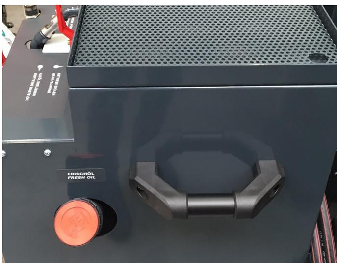
Die Neuauflagen des AGS 10 (oben) und des AGS 20 (unten) überzeugen mit praktischen Erweiterungen wie dem nach vorne verlegten Einfüllstutzen sowie einer Abtropfvorrichtung auf der Ablagefläche.
