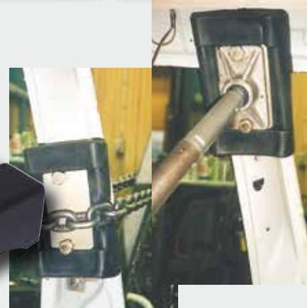
Mit Stahleinlage, hält den Druck von 100 Tonnen aus.
