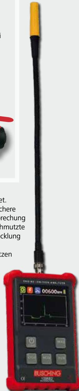
Anzeige von Brennabschnitt, Schließabschnitt, Brennspannungslinie, Drehzahl, Zündspannungsnadel
