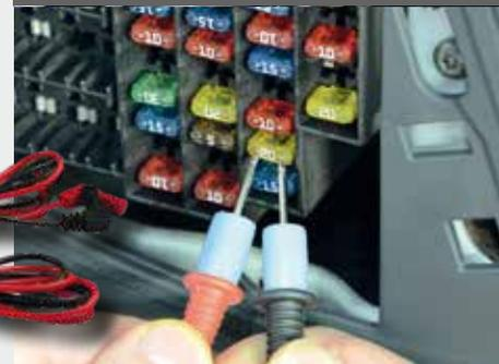
ANSCHLUSS MIT PRÜFSPITZEN
