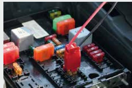
ANSCHLUSS MIT SICHERUNGSADAPTER
