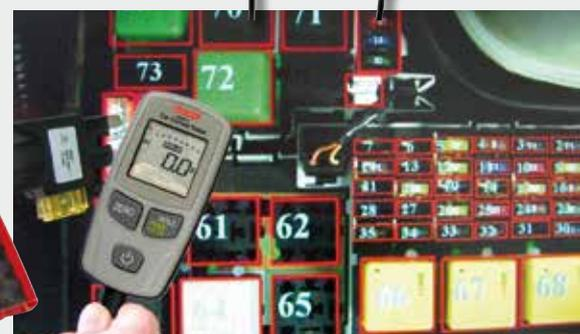
STROMSTÄRKENMESSUNG AM SICHERUNGSKASTEN
